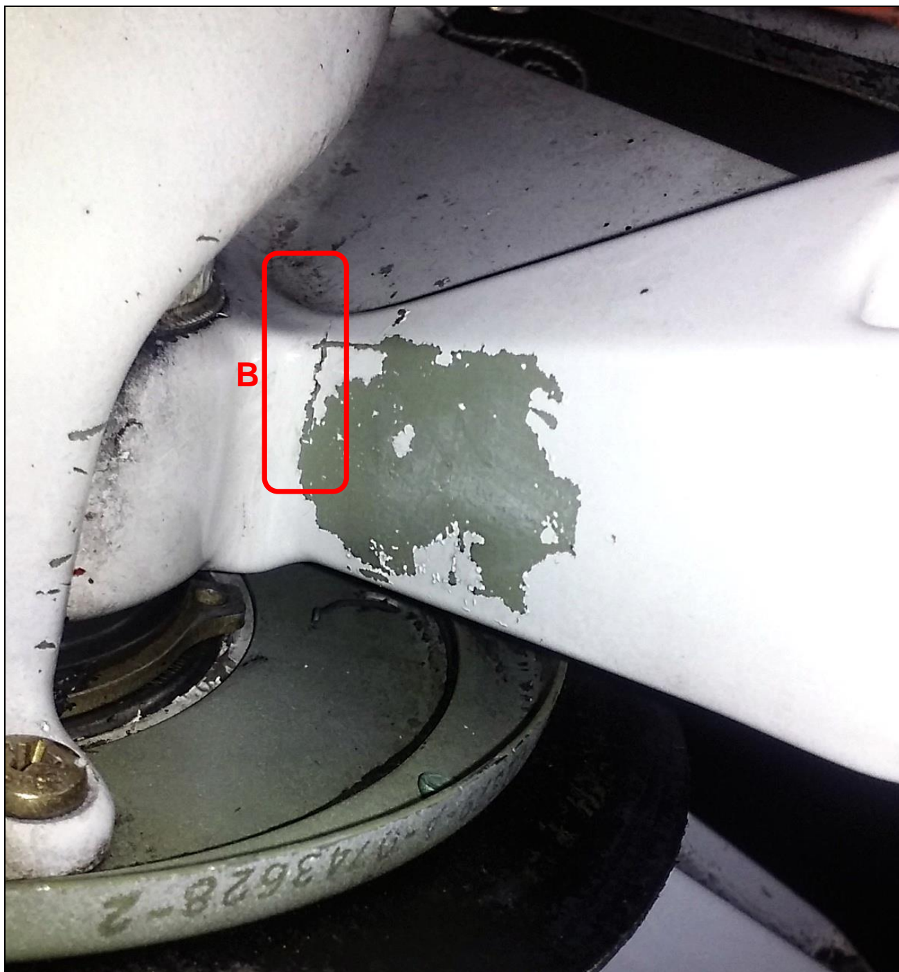
3 – Pęknięcie z lewej strony przy obejmie goleni podwozia (ozn."B" na ilustracji [1]).
