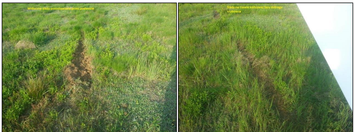
Rys.9÷10 Po lewej widoczne ślady pozostawione przez podwozie; po prawej ślady na trawie w końcowej fazie dobiegu szybowca
