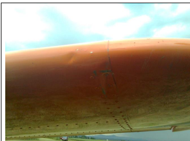
Rys. 2. Lekkie wgniecenie na czołowej części kesonu końcówki lewego skrzydła.
