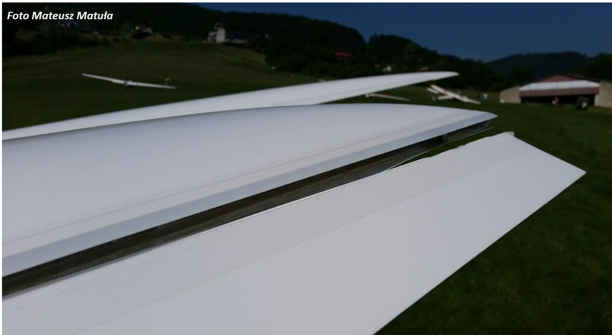
Uszkodzony ster wysokości – wyrwana z zawiasów prawa część usterzenia wysokości.
