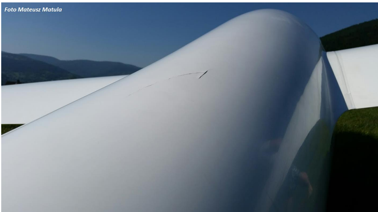
Pęknięcie pokrycia górnej powierzchni kadłuba.
