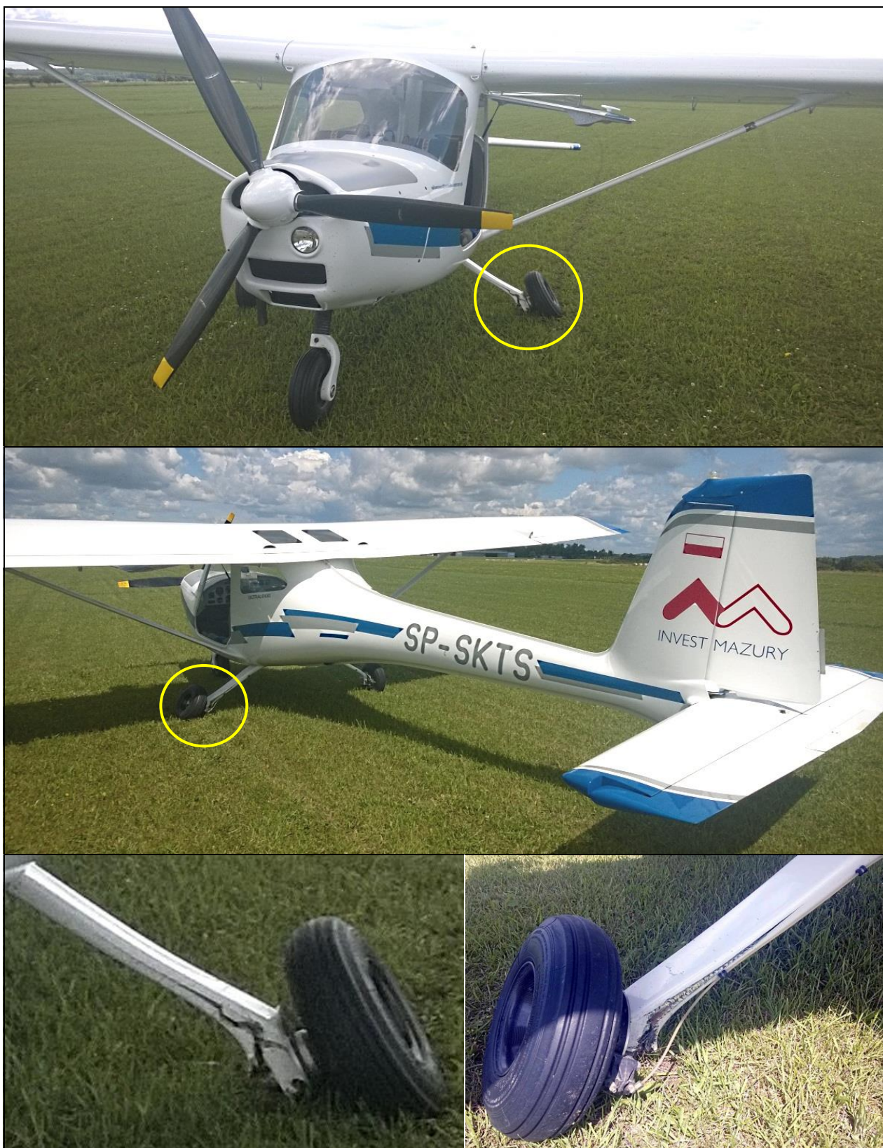
1, 2, 3, 4 - Ogólny widok uszkodzonego samolotu po wylądowaniu oraz zbliżenia na rozwarstwowaną goleń podwozia od przodu i od tyłu.
