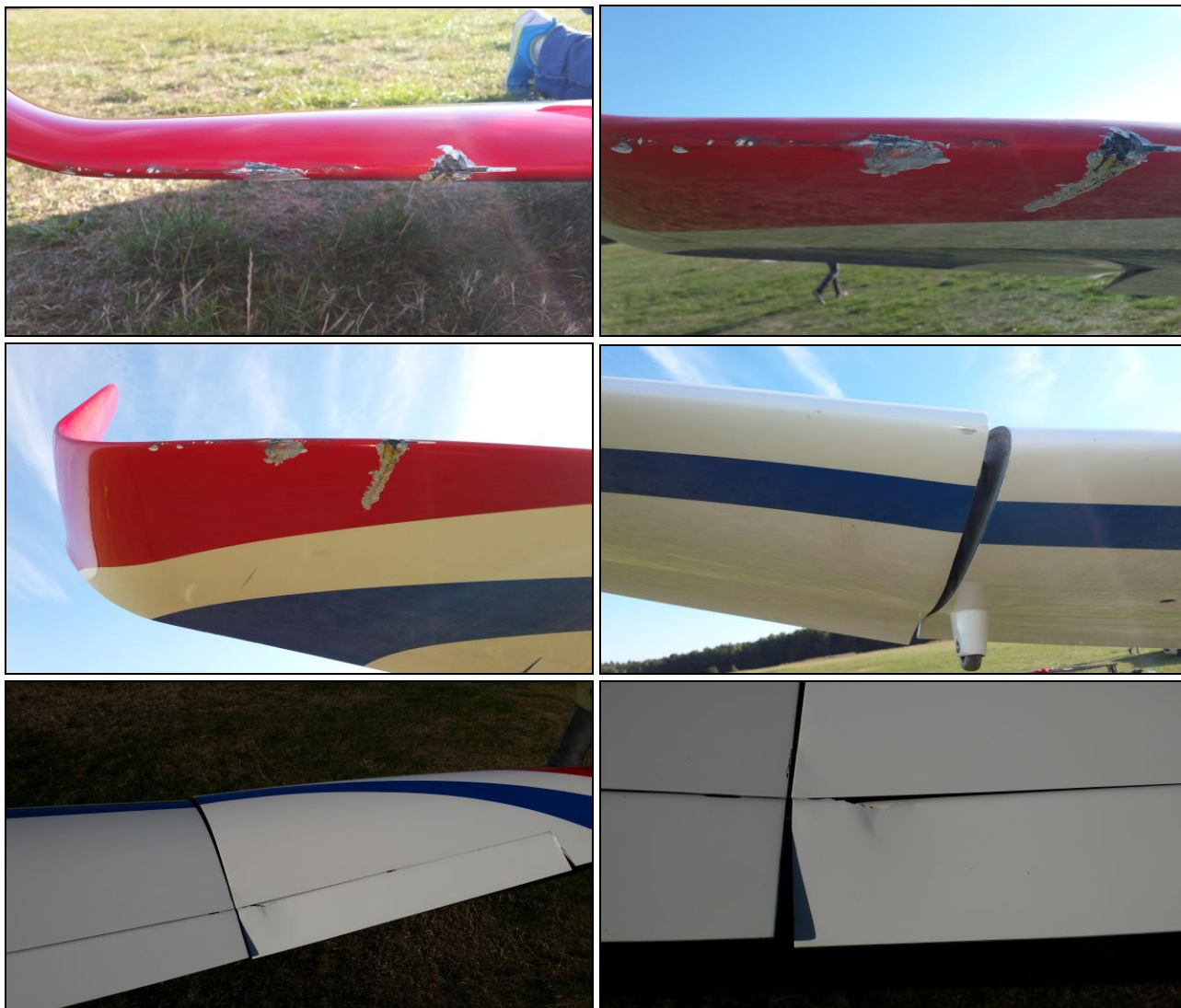
Rys.2÷7 Widoczne uszkodzenia końcówki prawego skrzydła na krawędzi natarcia oraz okucia łączącego lotkę końcówki skrzydła (fot. podmiot badający)
