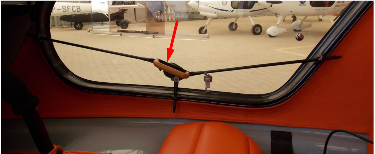
Rys. 6. Mechanizm zamykania drzwi prawych w pozycji „ZAMKNIĘTE-ZABEZPIECZONE”, ramię klamki po przejściu „martwego punktu” – przednia część klamki uniesiona do góry.
