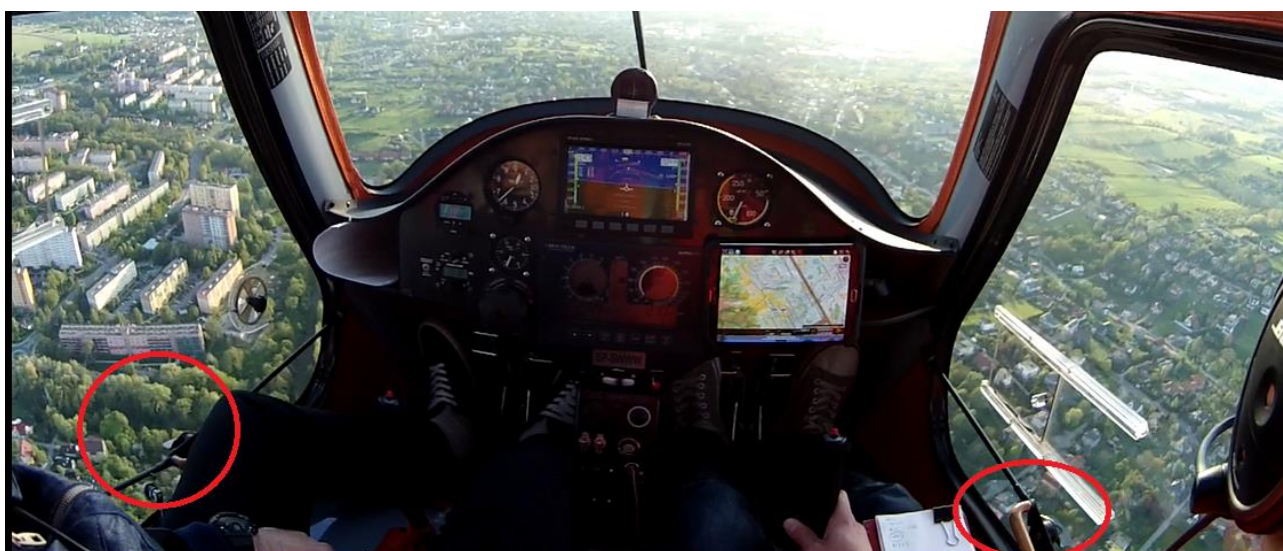
Rys. 3. Położenie klamek drzwi prawych i lewych podczas drugiej serii lotów – klamka prawa uniesiona do góry – zabezpieczona, klamka lewa opuszczona – niezabezpieczona.
