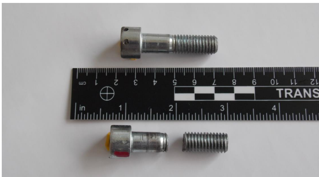
Rys. 1. Śruby M10 x 50 mocujące silnik do łoża. Śruba nieuszkodzona i śruba zerwana.
