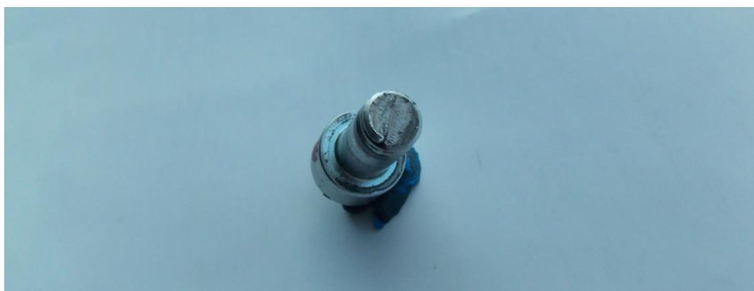
Rys. 2. Widok przełomu zerwanej śruby. Widoczne miejsce zainicjowania pęknięcia (ciemne - graniczące na obwodzie z gwintem). Pozostała, jasna część, to pęknięcie doraźne.
