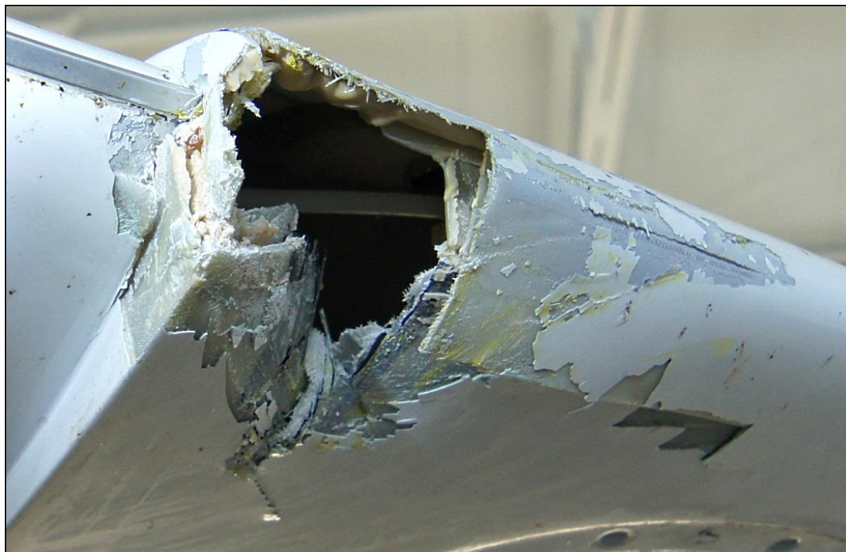
6 – Uszkodzenia noska lewego skrzydła – zbliżenie.
