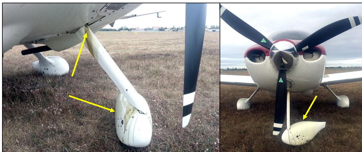
8, 9 – Ślady wycieku oleju na przednim podwoziu i owiewce koła.
