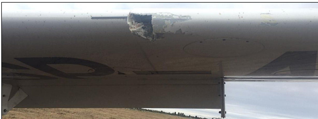
2 – Uszkodzenia lewego skrzydła dobrze widoczne przebite pokrycia noska i pęknięcia obok niego.
