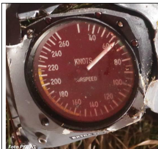
Ilustracja nr 4. Prędkościomierz samolotu zablokowany w momencie zderzenia z ziemią, wskazówka zatrzymał się na prędkości 64 kts. Świadczy to o tym, że samolot wykonywał korkociąg.
