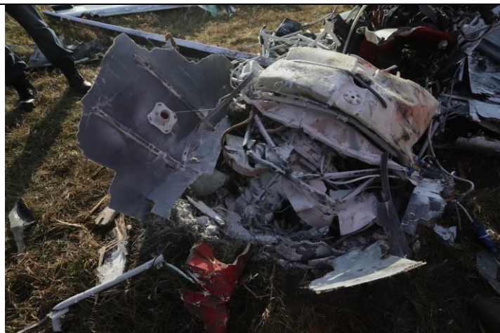
Ilustracja nr 9. Na ilustracji widać silnik pokryty proszkiem z gaśnicy i zniszczony centralny zbiornik paliwa.
