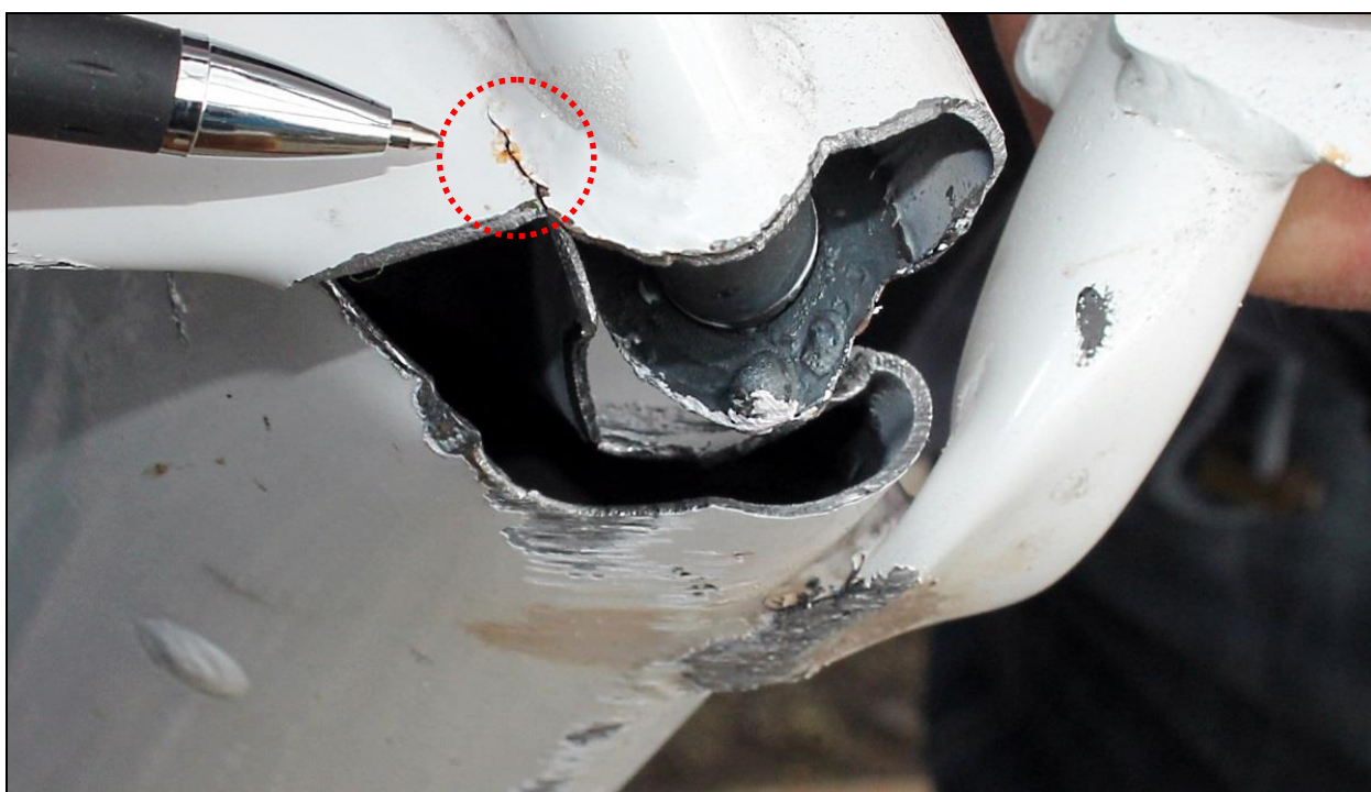
13 – Zbliżenie przełomu – zaznaczone miejsce wystąpienia korozji w spoinie [fot. Użytkownik samolotu].
