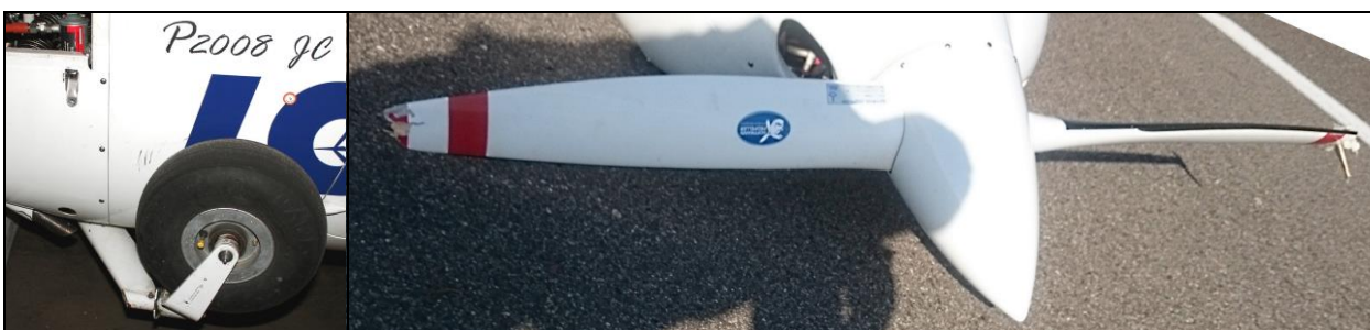
6, 7 – Zbliżenie na przednią część kadłuba – widoczne wyłamane podwozie przednie i uszkodzenia śmigła [fot. Użytkownik samolotu].
