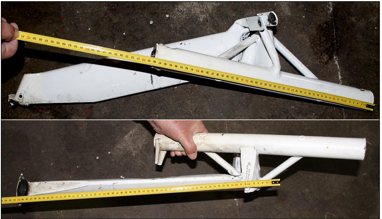
9, 10 – Złamana goleń podwozia przedniego zdemontowana z samolotu [fot. Użytkownik samolotu].
