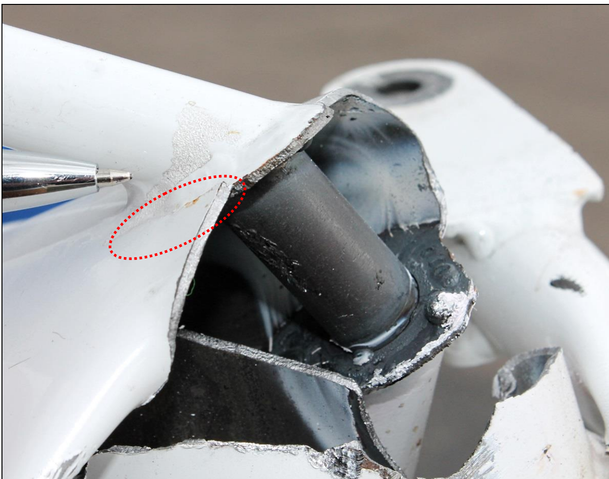
16 – Spoina w węźle konstrukcyjnym goleni – zaznaczona strefa pęknięcia spoiny [fot. Użytkownik samolotu].
