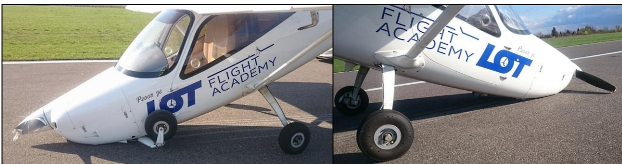
4, 5 – Zbliżenie na przednią część kadłuba – widoczne wyłamane podwozie przednie i uszkodzenia śmigła [fot. Użytkownik samolotu].
