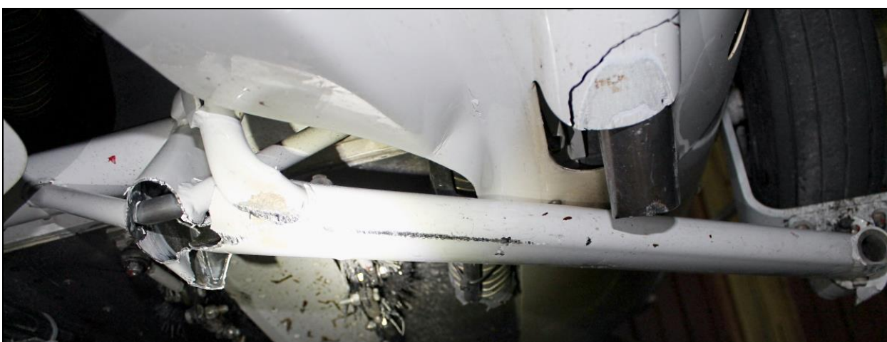
8 – Złamana goleń pod kadłubem samolotu [fot. Użytkownik samolotu].
