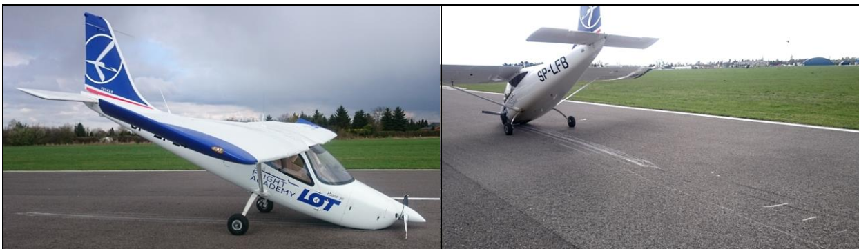
2, 3 – Ogólny widok samolotu na miejscu zdarzenia, widoczne ślady łopat śmigła i dolnej osłony silnika na asfaltowej nawierzchni drogi startowej [fot. Użytkownik samolotu].
