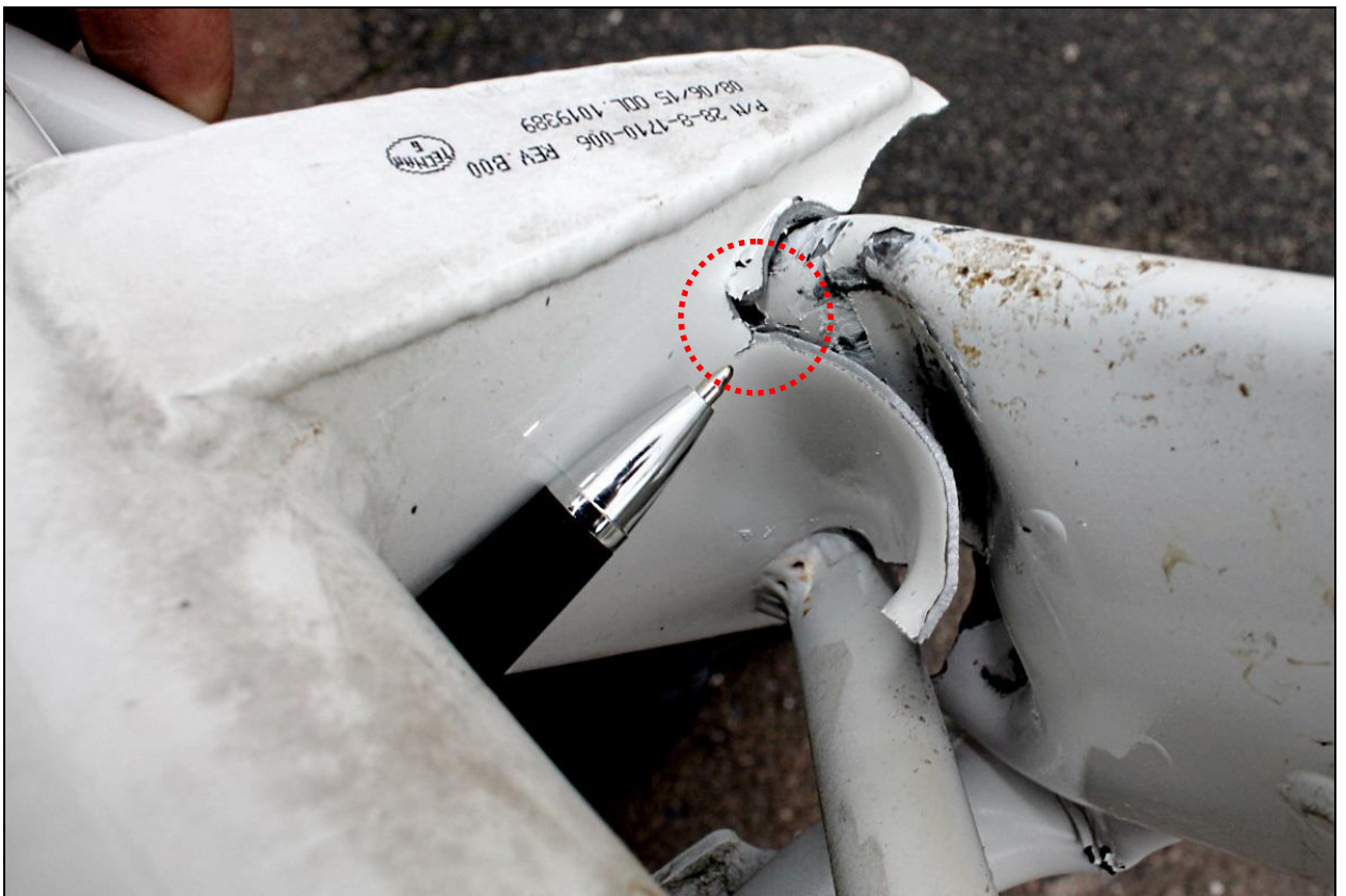
15 – Zbliżenie na strefę zniszczenia węzła goleni – początek pęknięcia spoiny [fot. Użytkownik samolotu].
