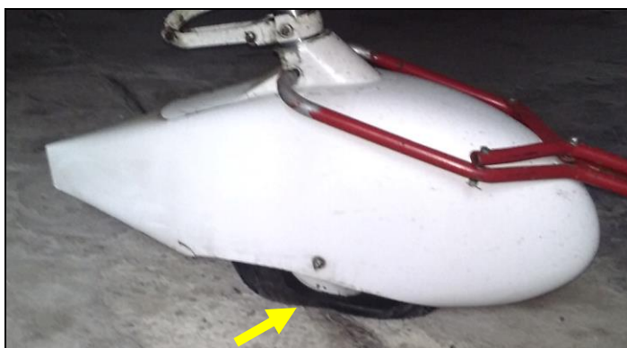
Przednie podwozie – brak powietrza w ogumieniu.
