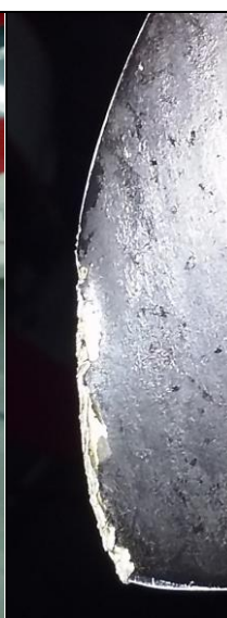
Uszkodzenia końcówek dwóch (z trzech) łopat śmigła.
