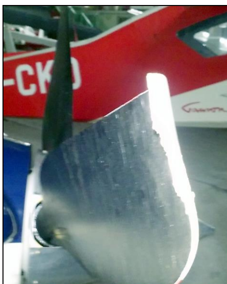
Uszkodzenia końcówek dwóch (z trzech) łopat śmigła.
