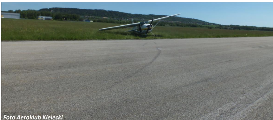
Ilustracja nr 2. Widok na samolot po zakończonym dobiegu. Widoczne ślady lewego koła.
