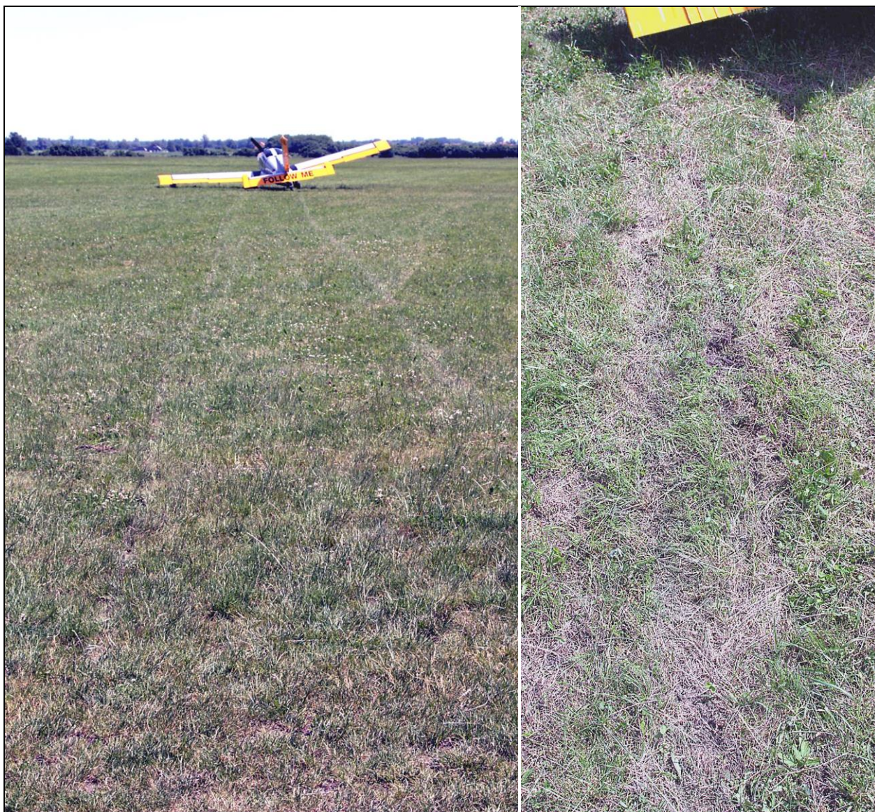
3, 4 – Ślady drugiego przyziemienia i ślady pozostawione przez uszkodzone podwozie.
