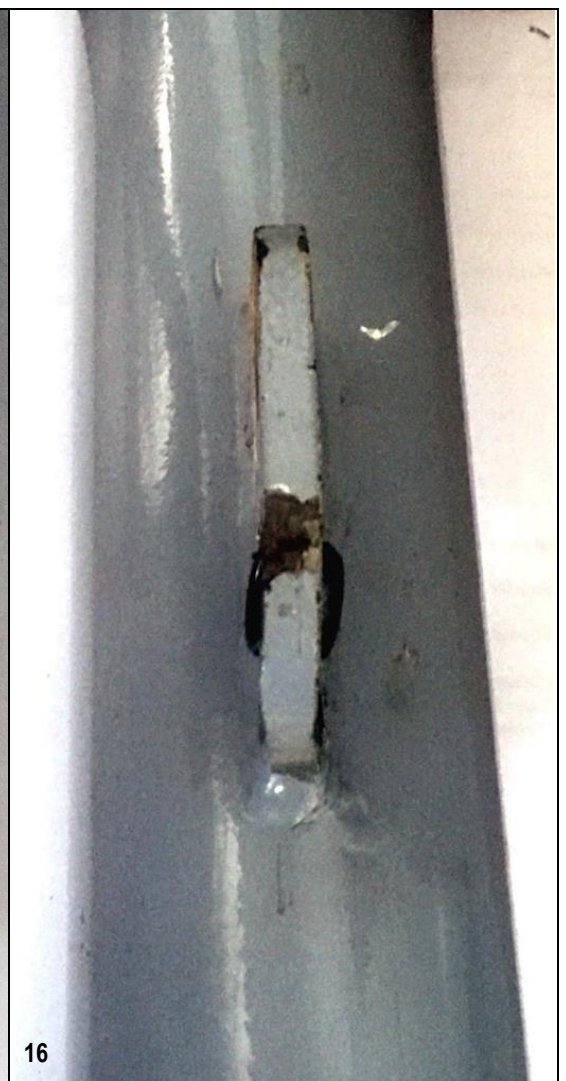
14, 15, 16 – Zniszczona oś wahacza koła lewego podwozia głównego [14], górna końcówka amortyzatora lewego podwozia głównego [15] oraz górne okucie amortyzatora i zastrzału goleni na goleni lewego podwozia [16]. Zauważalne odkształcenie widelca górnej końcówki amortyzatora.
