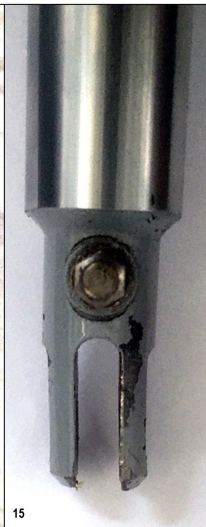
14, 15, 16 – Zniszczona oś wahacza koła lewego podwozia głównego [14], górna końcówka amortyzatora lewego podwozia głównego [15] oraz górne okucie amortyzatora i zastrzału goleni na goleni lewego podwozia [16]. Zauważalne odkształcenie widelca górnej końcówki amortyzatora.
