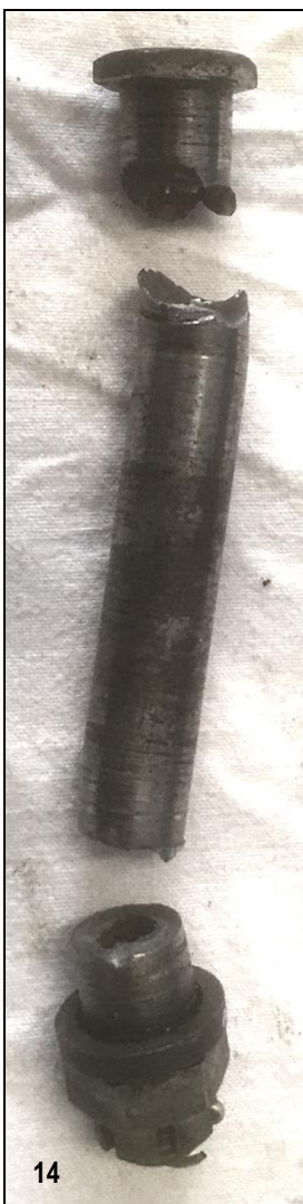
14, 15, 16 – Zniszczona oś wahacza koła lewego podwozia głównego [14], górna końcówka amortyzatora lewego podwozia głównego [15] oraz górne okucie amortyzatora i zastrzału goleni na goleni lewego podwozia [16]. Zauważalne odkształcenie widelca górnej końcówki amortyzatora.
