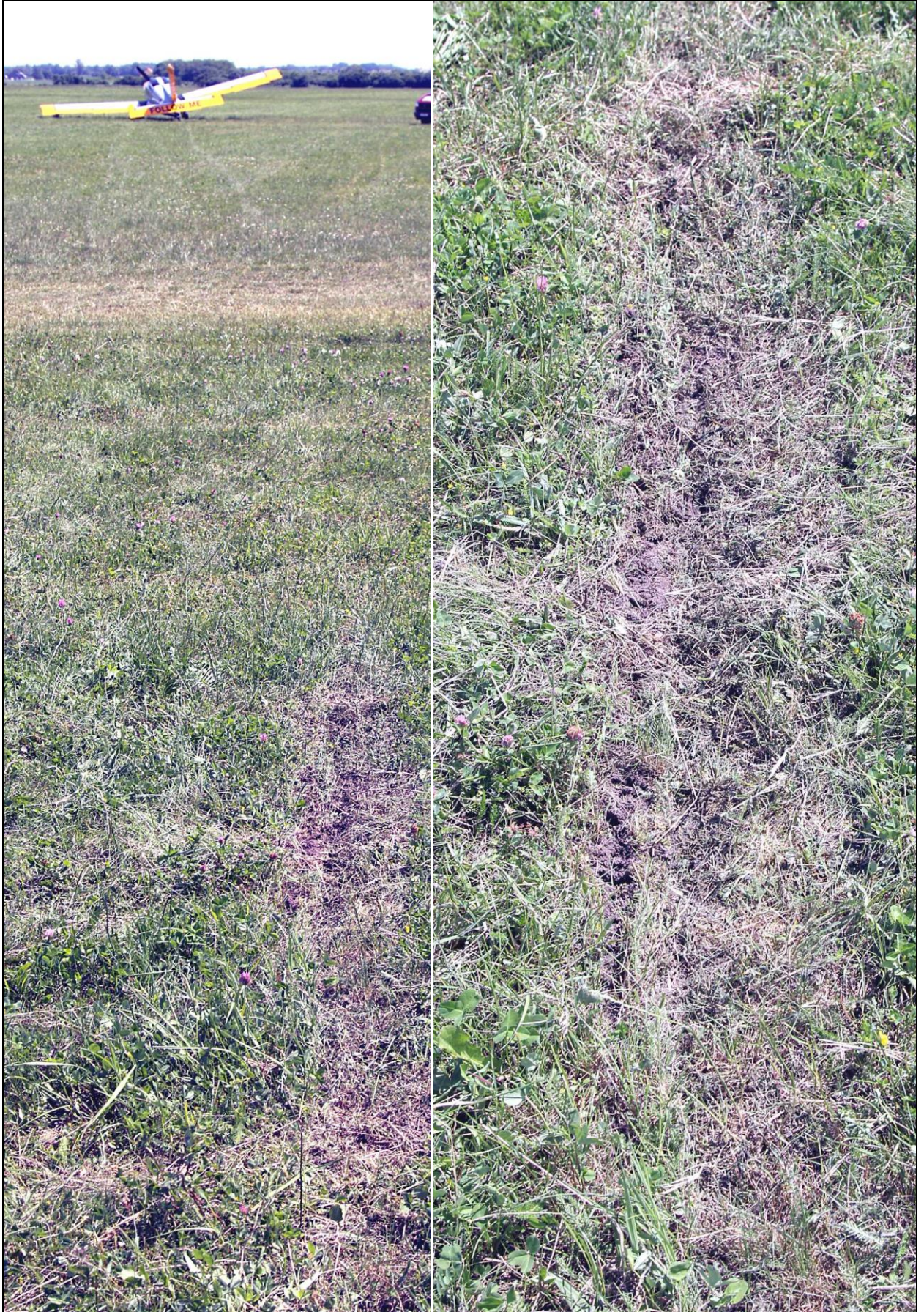
1, 2 – Ślady pierwszego przyziemienia samolotu [wszystkie ilustracje w niniejszym raporcie: Użytkownik samolotu]. Wyrównanie zostało wykonane na wysokości ok. 3 m nad powierzchnią pasa, po czym nastąpiło dynamiczne przyziemienie z przepadnięcia z lekkim przechyleniem na lewe skrzydło. Lewe koło
