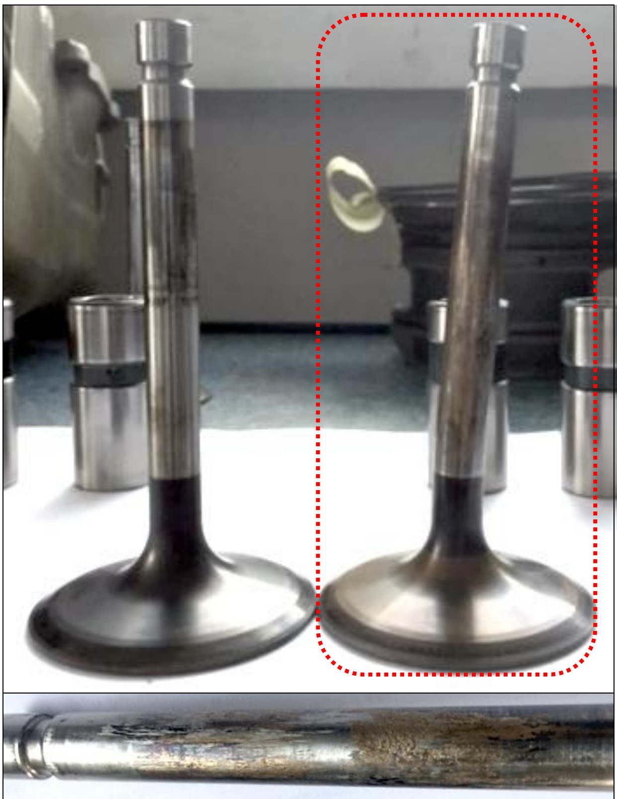
1, 2 – Grzybki zaworowe zdemontowane z silnika (po prawej uszkodzony – zagięty – pochodzący z zaworu ssącego cylindra nr 1; na zdjęciu dolnym jego trzonek z objawami zatarcia.
