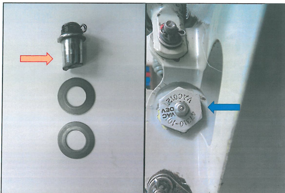
Rys. 5. Uszkodzony sworzień P/N 47310-101 (czerwoną strzałką pokazano fragment sworznia znaleziony na miejscu zdarzenia, niebieską strzałką pokazano fragment który pozostał w swoim gnieździe w UPPER LOCK LINK P/N 47320-3).
