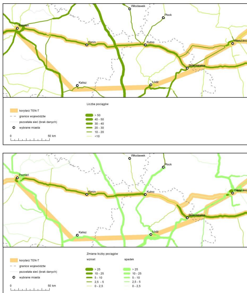
Ryc. 3.11. Średniodobowe natężenie ruchu pociągów towarowych w 2010 r. (rycina na górze) oraz zmiany natężenia ruchu pociągów towarowych w latach 2000-2010 (rycina na dole) w części środkowej segmentu wschód-zachód
