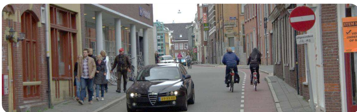
Ulica jednokierunkowa z kontrapasem rowerowym.
