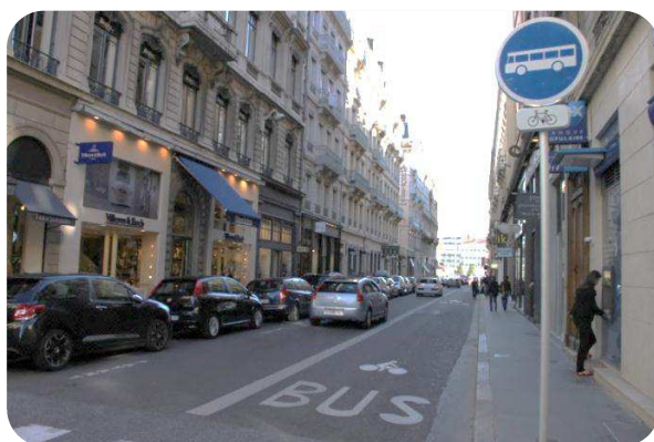
Pas autobusowy wyznaczony na ulicy jednokierunkowej, z dopuszczonym ruchem rowerowym.
