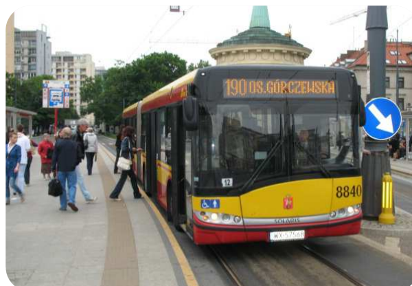
Wspólne torowisko tramwajowo-autobusowe na Trasie WZ.
