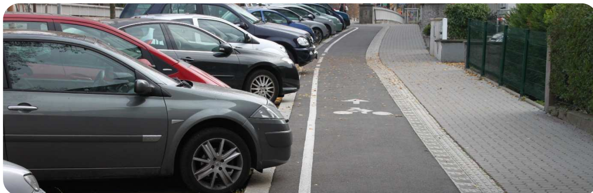
Przykład bufora bezpieczeństwa oddzielającego zatokę parkingową i drogę dla rowerów.
