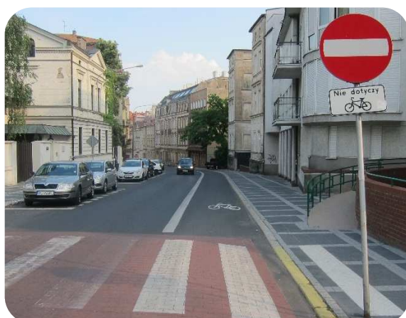
Przykłady zwężeń jednokierunkowej jezdni i zastosowania kontrapasów rowerowych.
