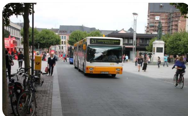
Ulica w strefie pieszej z dopuszczoną komunikacją autobusową, bez wyraźnego wyodrębnienia jezdni.
