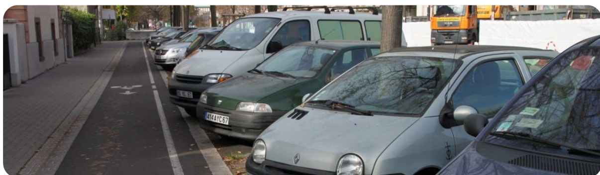
Pas buforowy zabezpieczający przed ograniczeniem skrajni ruchu rowerowego przez parkujące samochody.
