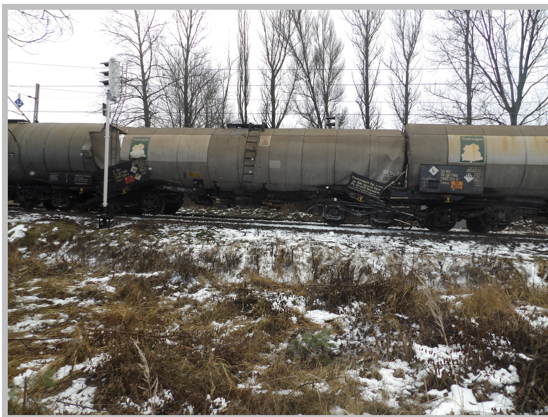
Zdjęcie nr 2. Uszkodzone wagony poc. nr 362012
