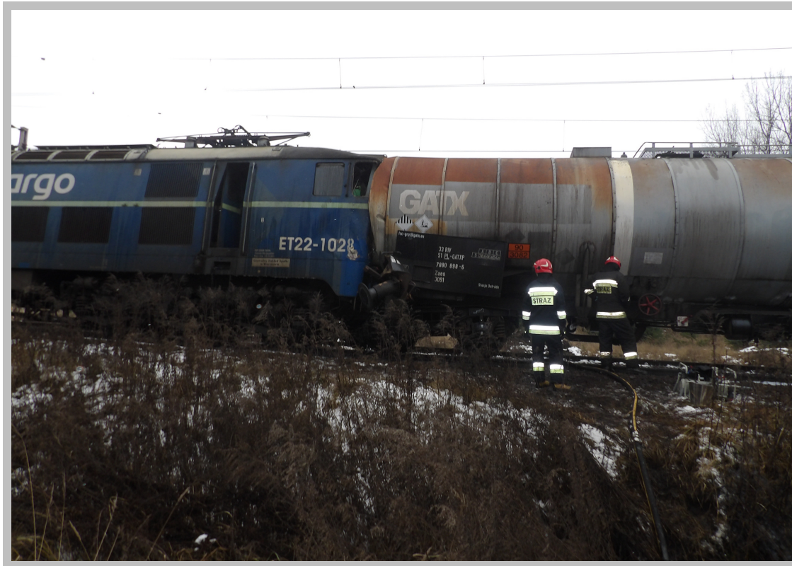
Zdjęcie nr 1. Efekt najechania lokomotywy poc nr 452012 na tył poc. nr 362012
