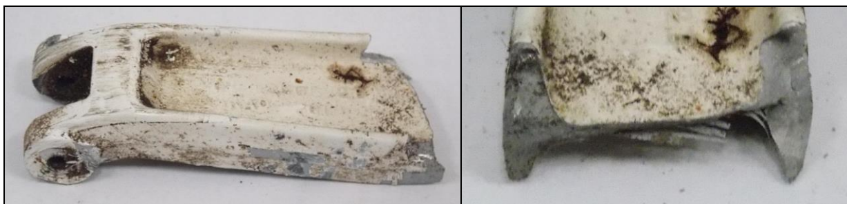
35, 36 – Złamana dolna połówka nożyc przedniego podwozia i jej przełom w zbliżeniu.
