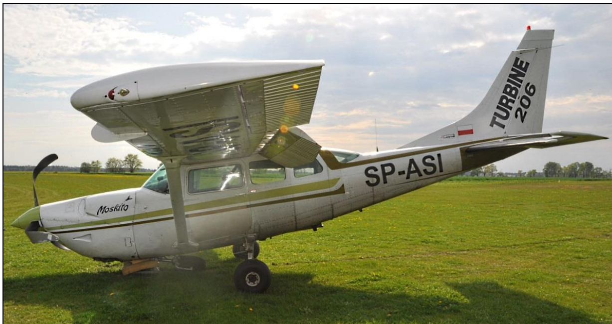
20 – Samolot po zatrzymaniu na miejscu wypadku, lewa strona. Dobrze widoczne wychylone do lądowania kłapy i zniszczone śmigło (przednia część kadłuba już podparta) [foto: Aeroklub Słupski].
