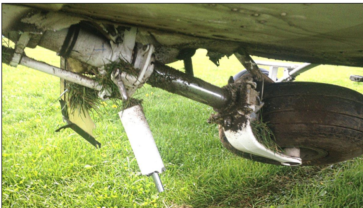
23 – Złamane przednie podwozie po uniesieniu przedniej części kadłuba, lewa strona – zbliżenie [foto: pilot samolotu].
