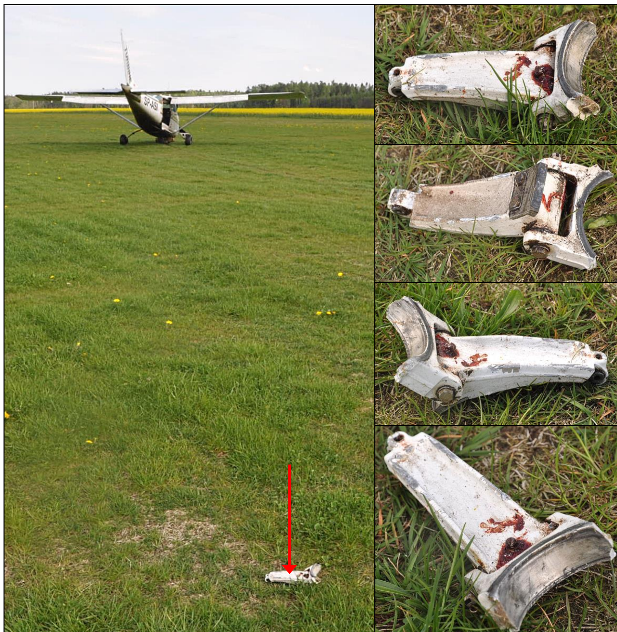
8, 9, 10, 11, 12 – Odłamana wraz z fragmentem obejmy mocującej górna połówka nożyc przedniego podwozia, odnaleziona w pobliżu śladów samolotu [foto: Aeroklub Słupski].
