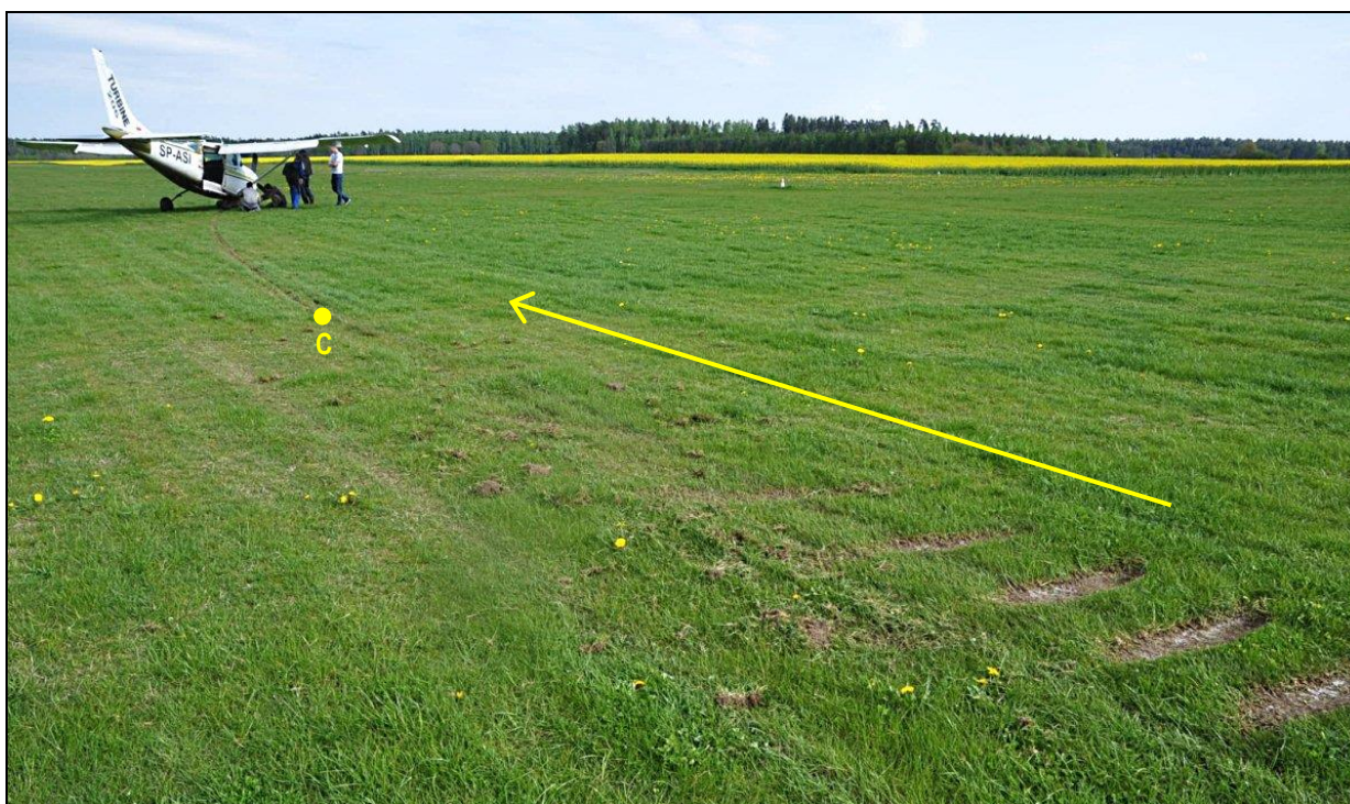
16 – Koniec śladów łopat śmigła i początek szerokiej bruzdy - śladu elementów złamanego podwozia (punkt C na ilustracji 2) [foto: Aeroklub Słupski].
