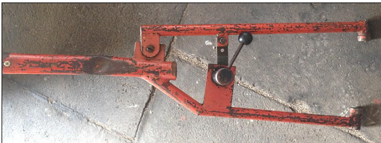
34 – Dyszel-wodzydło, używane podczas holowania samolotu po ziemi [foto: pilot samolotu].
