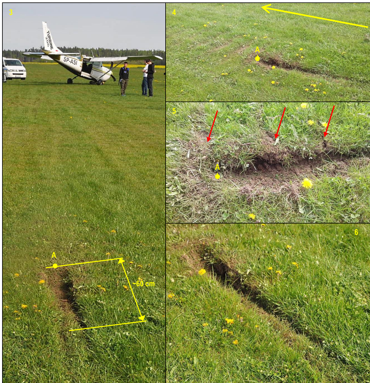
3, 4, 5, 6 – Pierwszy ślad przedniego podwozia (punkt A z ilustracji 2). Większa bujność trawy i większa ilość kwiatów mogą świadczyć o większej lokalnej wilgotności gleby, czyli możliwej grząskości. Na zdjęciu 5 (wykonanym wcześniej od pozostałych) widoczne ślady łopat śmigła w poprzek śladu koła podwozia [foto: Aeroklub Słupski].
