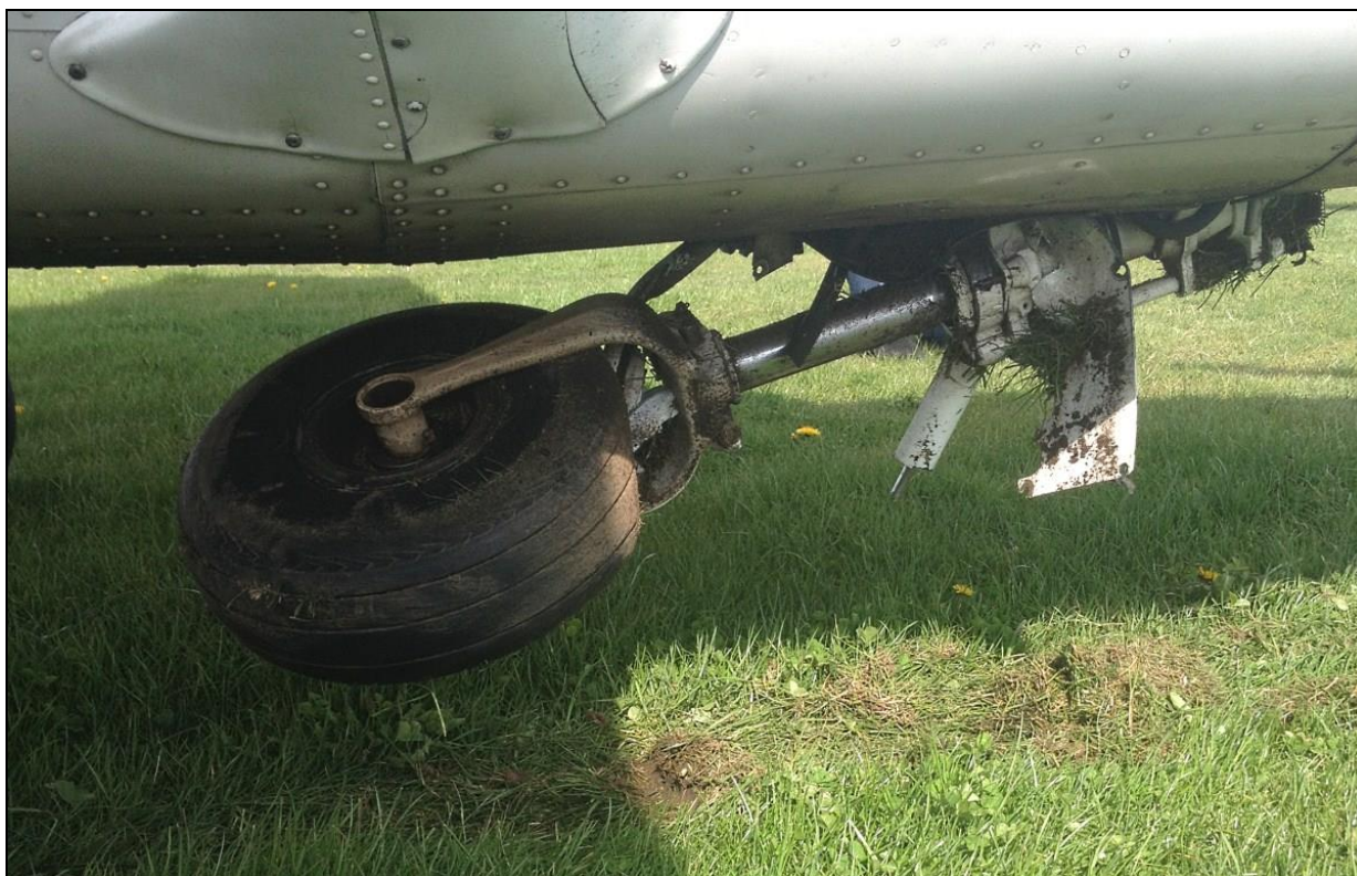
24 – Złamane przednie podwozie po uniesieniu przedniej części kadłuba, prawa strona – zbliżenie [foto: pilot samolotu].
