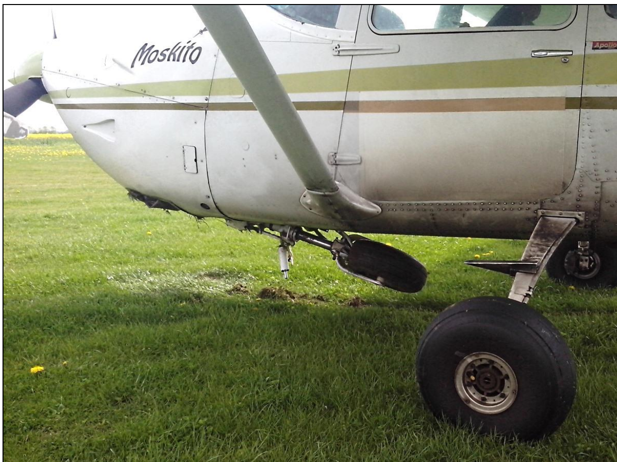
22 – Złamane przednie podwozie po uniesieniu przedniej części kadłuba, lewa strona [foto: pilot samolotu].
