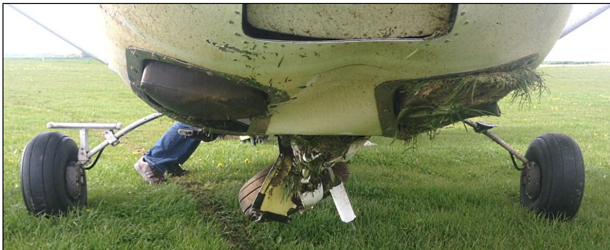
26 – Wyłamane przednie podwozie, zniszczone rury wylotowe spalin z silnika i uszkodzona, zdeformowana dolna osłona silnika, widok od przodu samolotu [foto: pilot samolotu].
