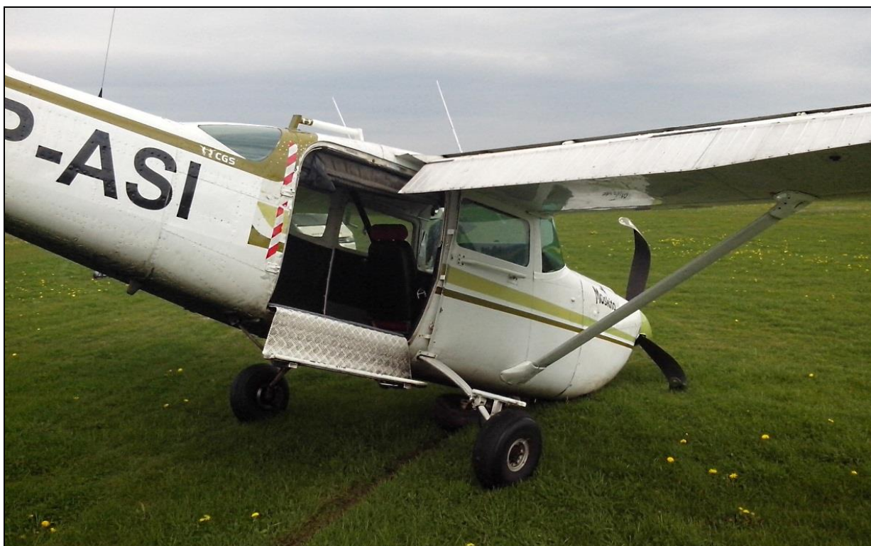
27 – Samolot z prawej strony – zbliżenie na otwarte drzwi desantowe. Widoczne wychylone do lądowania kłapy i zniszczone śmigło [foto: Aeroklub Słupski].
