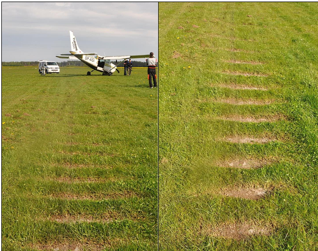
14, 15 - Szerokie i głębokie wybrania murawy wskutek kontaktu pociętych łopat obracającego się śmigła z nawierzchnią lotniska – zbliżenia [foto: Aeroklub Słupski].
