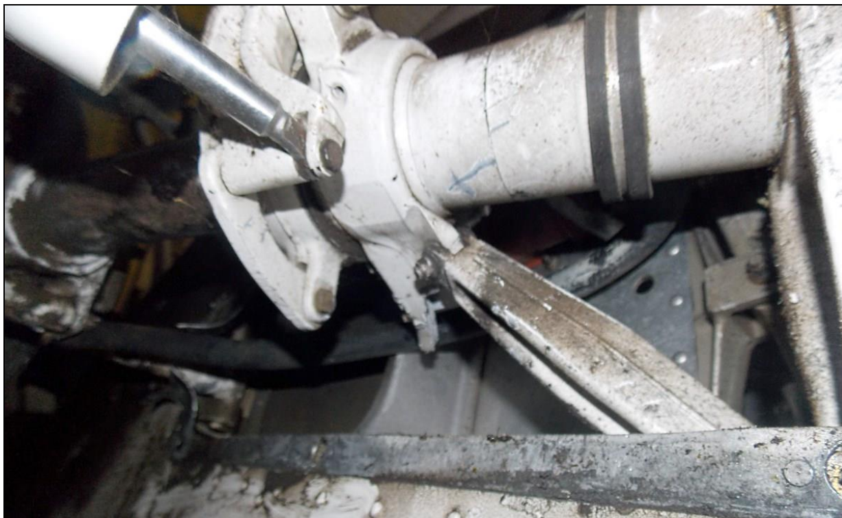
43 – Zbliżenie na elementy górnego węzła goleńi podwozia.
