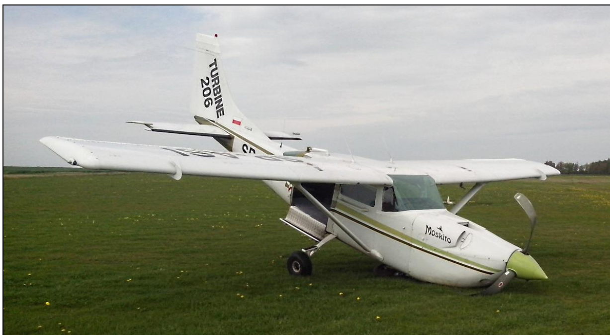
21 – Samolot po zatrzymaniu na miejscu wypadku, prawa strona. Dobrze widoczne zniszczone śmigło (przednia część kadłuba jeszcze nie podparta paletami) [foto: Aeroklub Słupski].
