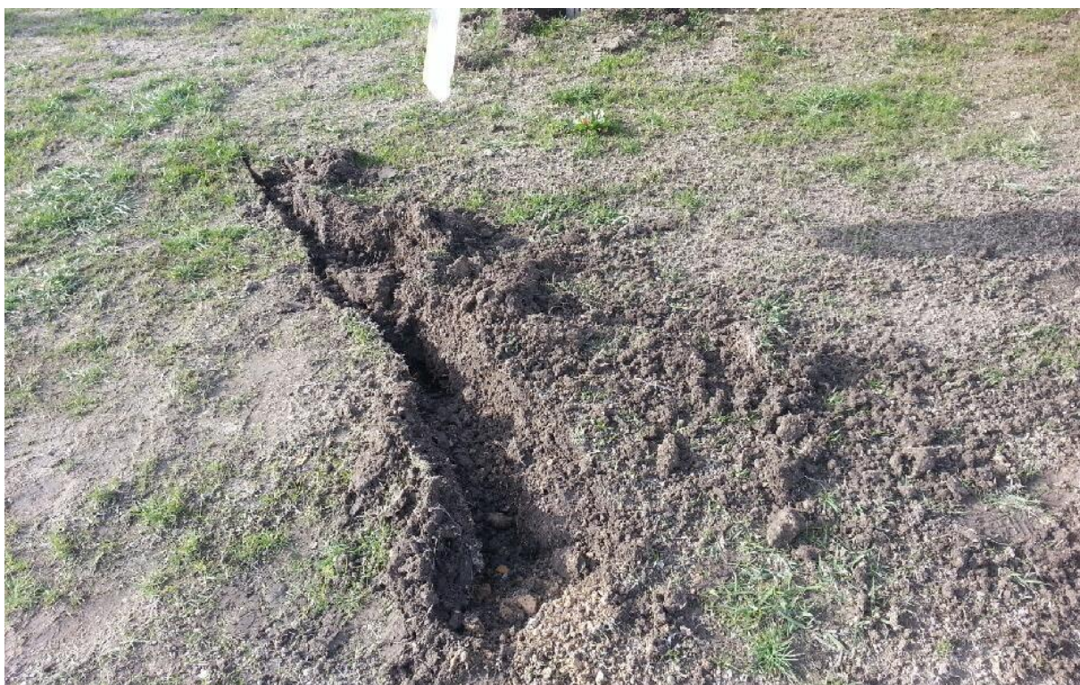
Ślad po śmigle na nawierzchni lotniska
