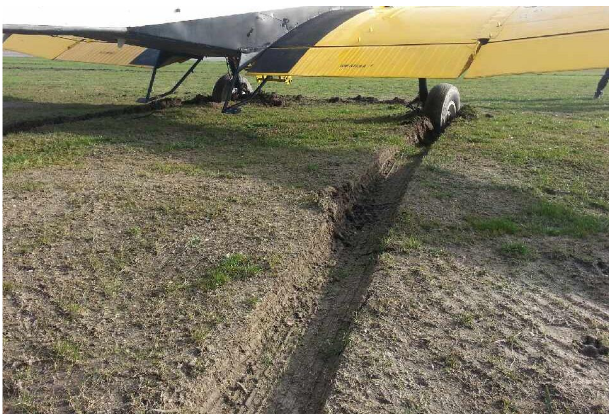
Stopniowo pogłębiające się w gruncie koleiny po kołach podwozia głównego
