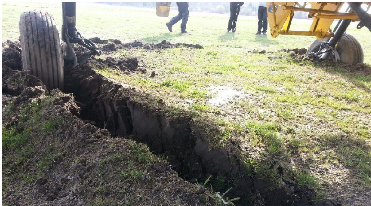
Zagłębienie kół podwozia głównego w podmokłej nawierzchni lotniska
