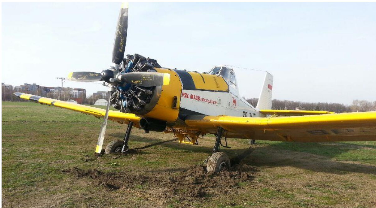
Samolot wkołowaniu na podmokły grunt lotniska. Zdjęcie wykonane po zdarzeniu.
