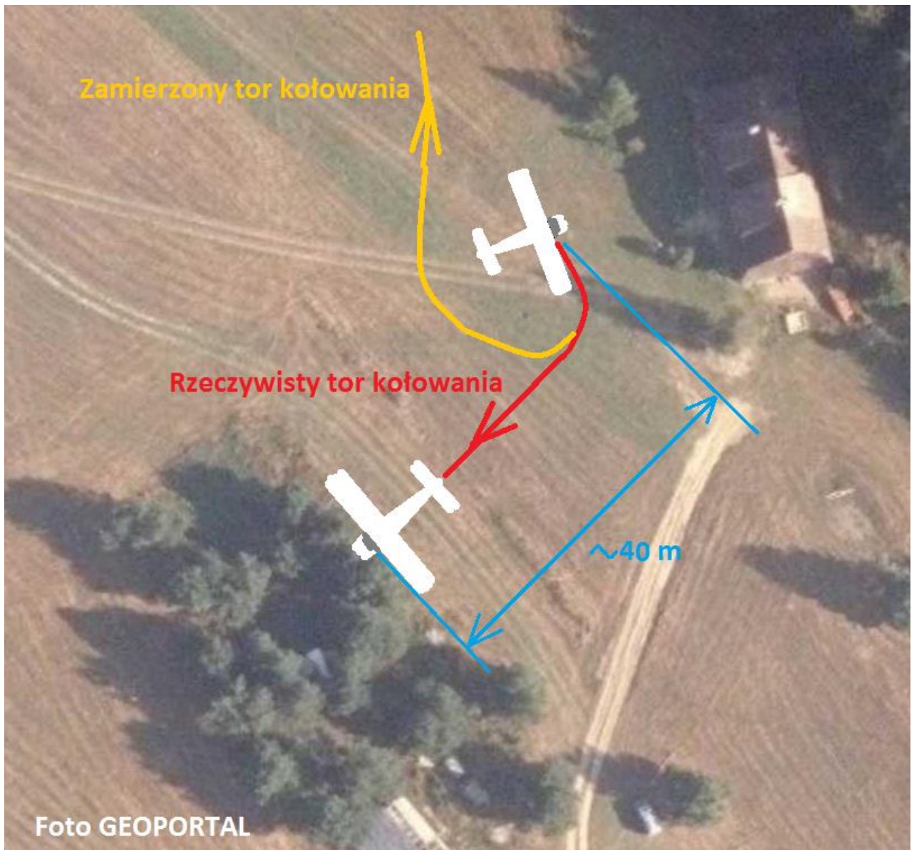
Rys. 2. Szkic zamierzonego i rzeczywistego toru kołowania/poślizgu samolotu podczas próby zmiany miejsca parkowania.
