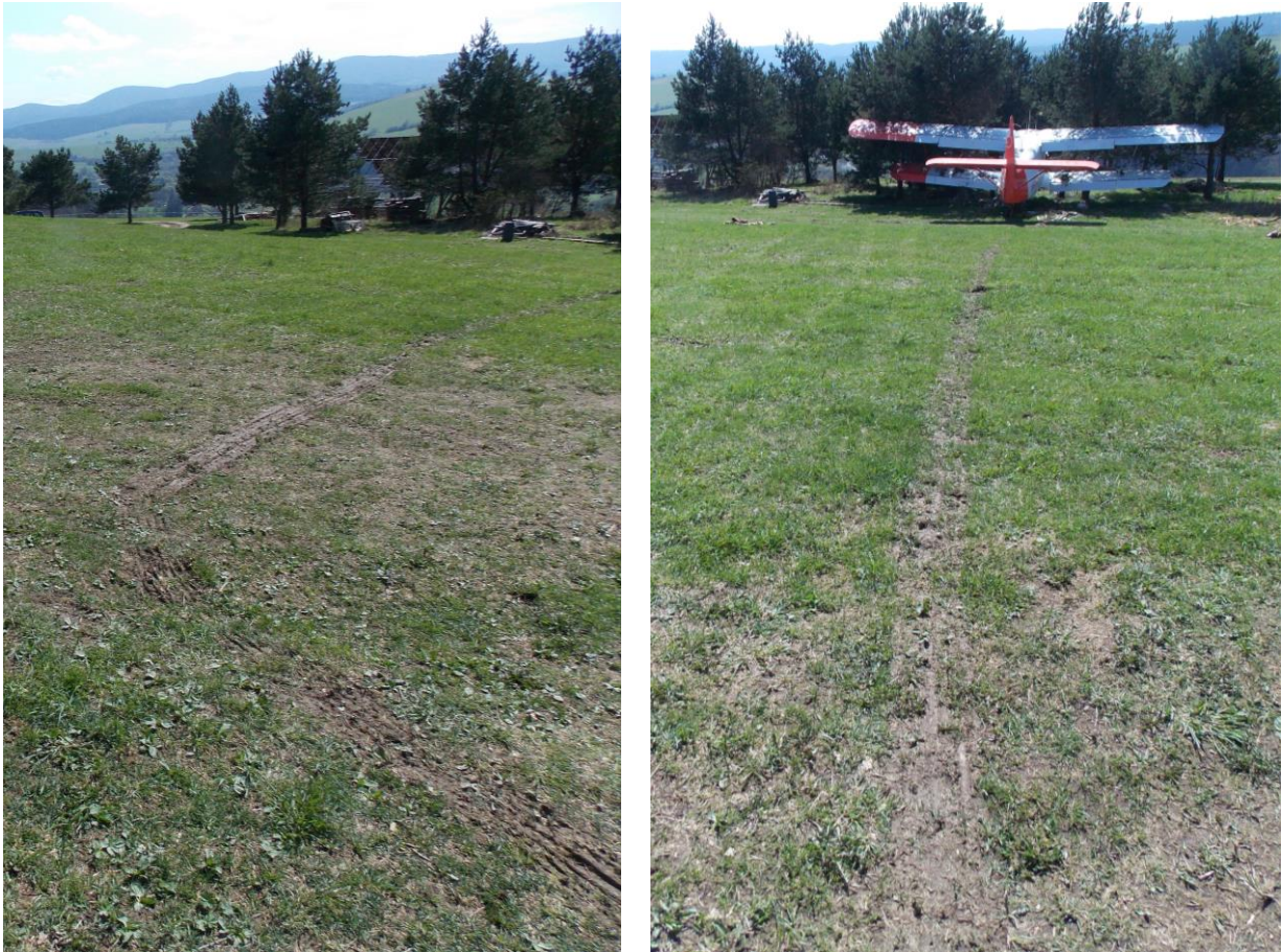
Rys. 3. Ślady prawego koła podwozia głównego w początkowej fazie zakrętu (foto po lewej) oraz ślad jaki pozostawił na stoku staczający się samolot, widoczny na dalszym planie (foto po prawej).
