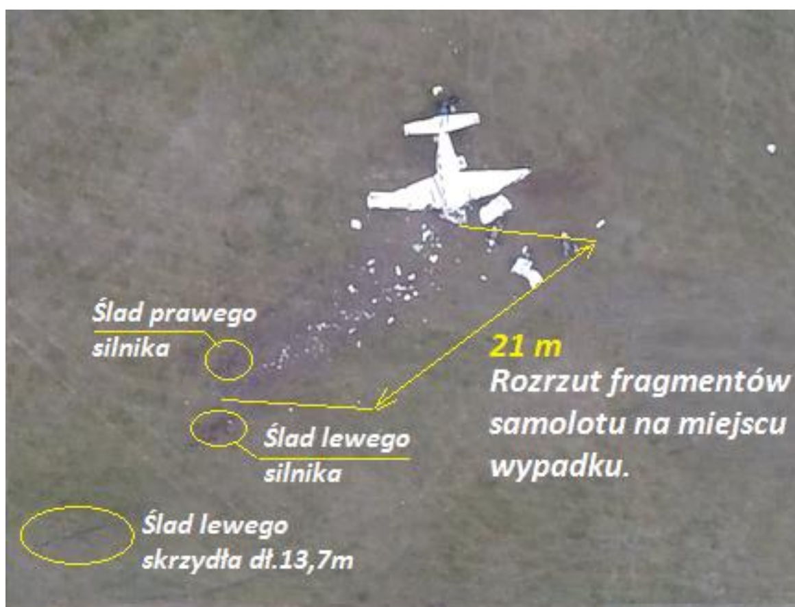
Rys.16. Rozrzut fragmentów samolotu na miejscu wypadku [foto AZL]
