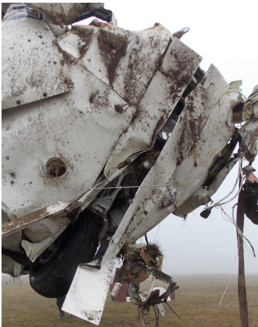
Rys. 13. Podwozie przednie po wypadku w położeniu „schowane”. Osłony zamknięte. Widoczne odkształcenia osłon są wynikiem zderzenia nosowej części kadłuba z murawą w końcowej fazie autorotacji.
