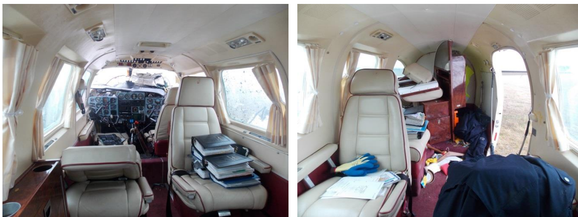
Rys. 9. Kabina pasażerska po wypadku. Zdjęcie po lewej, widok do przodu – brak oparcia fotela pilota wyciętego podczas akcji ratowniczej. Zdjęcie po prawej, widok do tyłu.
