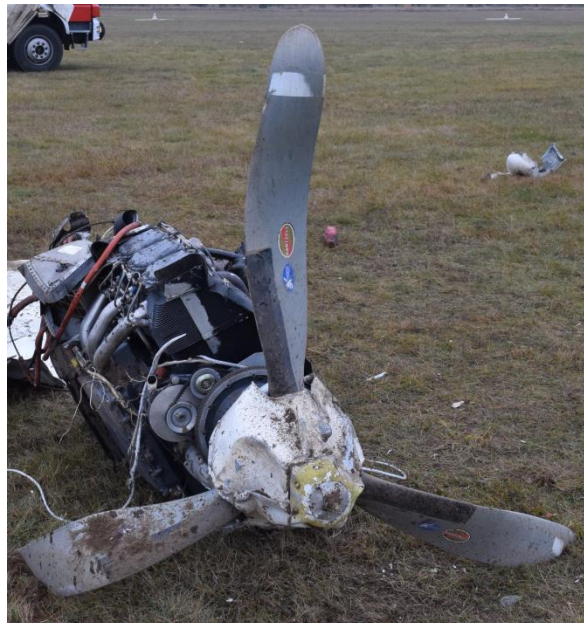
Rys. 6. Zdjęcie powyżej obrazujące stan łopat śmigła lewego silnika, t.zw. „tulipan” oraz zdjęcie po prawej, które pokazuje mniej odkształcone łopaty prawego silnika (za wyjątkiem jednej). [foto Policja]
