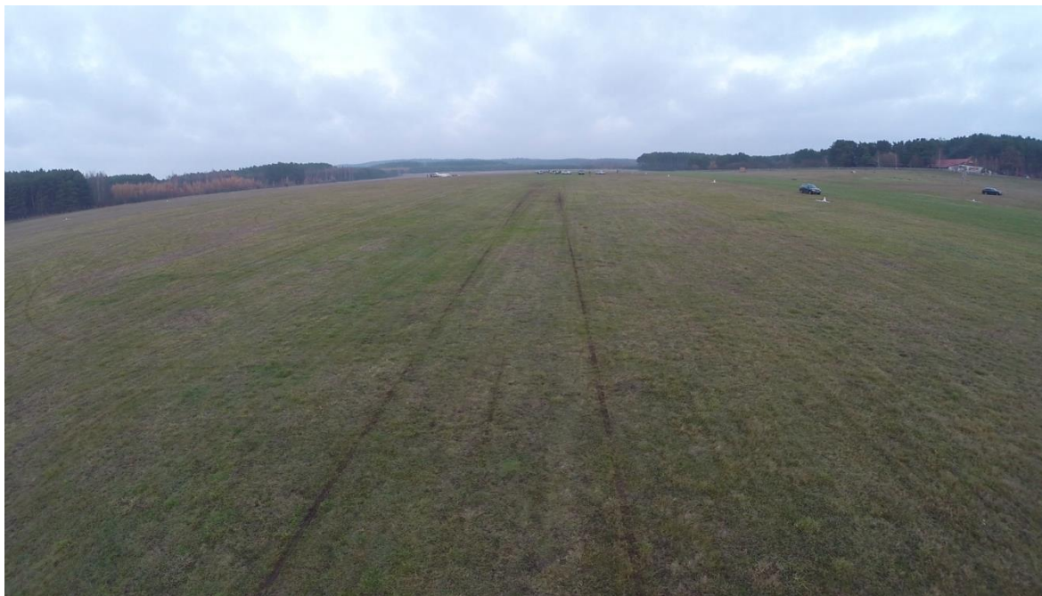
Rys.2. Pierwszy ślad koła przedniego podwozia na murawie DS06
