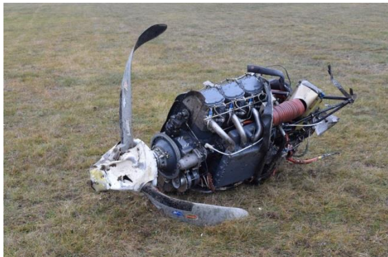
Rys. 6. Zdjęcie powyżej obrazujące stan łopat śmigła lewego silnika, t.zw. „tulipan” oraz zdjęcie po prawej, które pokazuje mniej odkształcone łopaty prawego silnika (za wyjątkiem jednej). [foto Policja]
