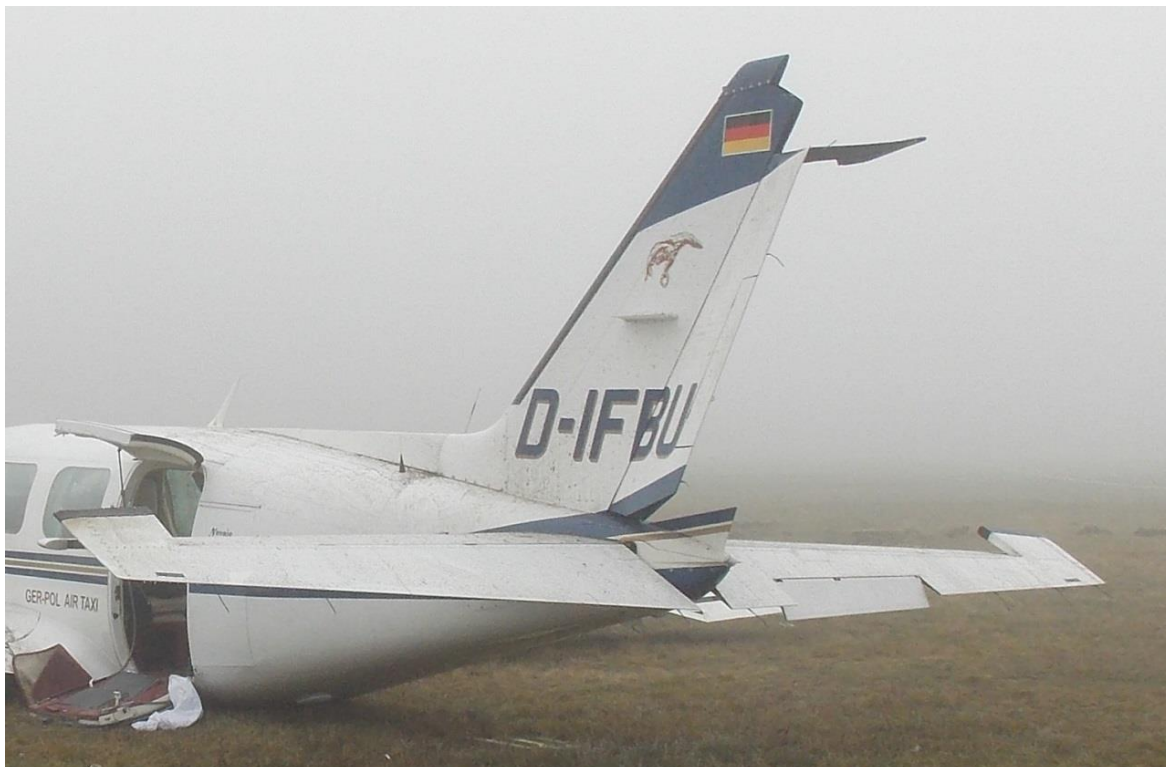
Rys. 10. Uszkodzenie górnej części steru kierunku. Widoczna wygięta górna część steru kierunku z noskiem wyważenia aerodynamicznego.
