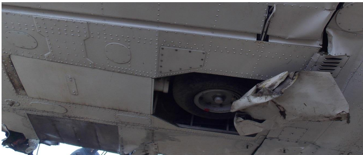
Rys. 12. Stan lewego podwozia głównego po wypadku - „podwozie schowane”. Wewnętrzna osłona gondoli podwozia zniekształcona kontaktem z nawierzchnią lotniska i niedomknięta, osłona zewnętrzna zamknięta.
