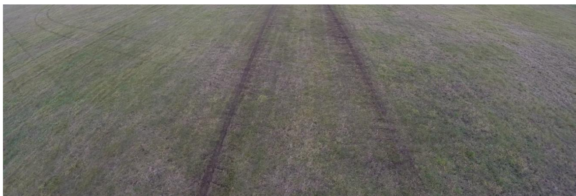
Rys. 15. Koleiny i ślady śmigieł w środkowej części DS06/24 po rozbiegu.
