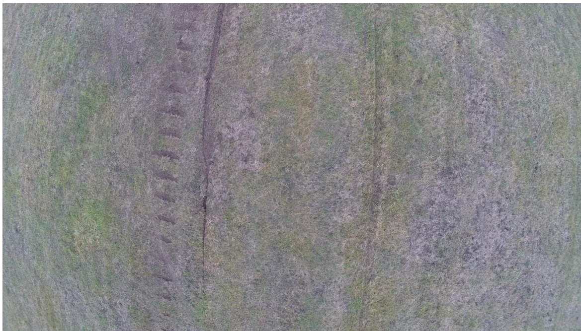
Rys.4. Ślady na murawie DS06 w końcowej fazie rozbiegu. Po lewej ślad wewnętrznej osłony gondoli lewego koła głęboko wcinającej się w murawę oraz ślad śmigła lewego silnika. Po prawej widzimy tylko zanikający ślad prawego koła.
