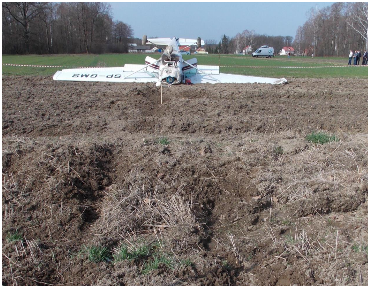
Rys. 1. Położenie samolotu na miejscu wypadku. Widoczne ślady kół podwozia po przyziemieniu. [foto PKBWL]
