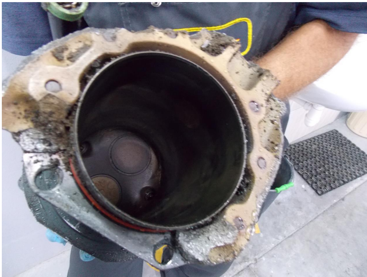
Rys. 9. Kolnierz cylindra nr 2 z fragmentem korpusu slika. [foto PKBWL]
