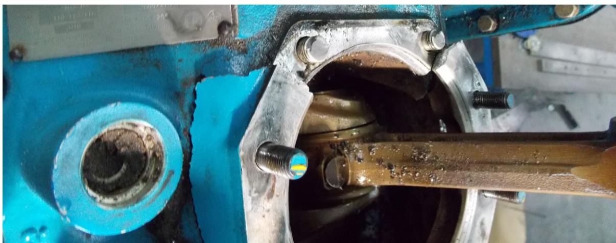
Rys. 13. Uszkodzenia korpusu silnika u podstawy cylindra nr 2. Widoczne czola zerwanych szpilek [foto PKBWL]
