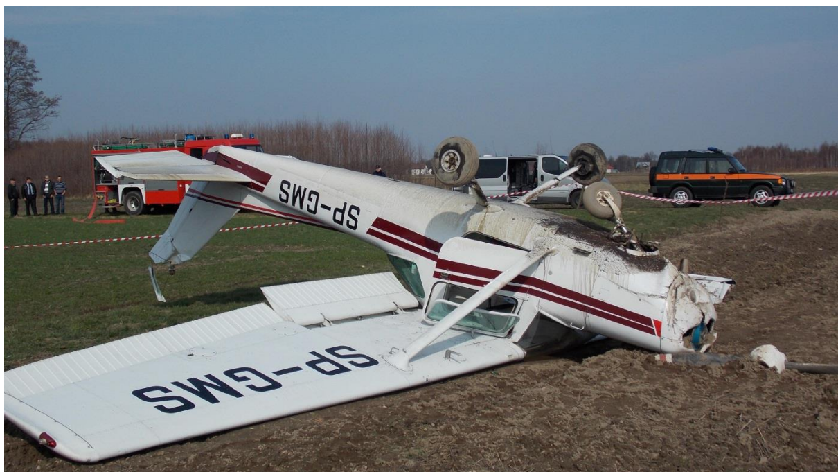
Rys. 2. Lewa strona samolotu. Widoczne oddzielone śmigło, wylamana przednia goleń, uszkodzone ster kierunku i statecznik pionowy oraz ślady oleju na spodzie kadłuba i statecznika poziomego. [foto PKBWL]
