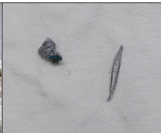
Rys. 14. Po lewej, zanieczyszczenia filtra niemagnetycznymi cząstkami stałymi. [foto PKBWL]
