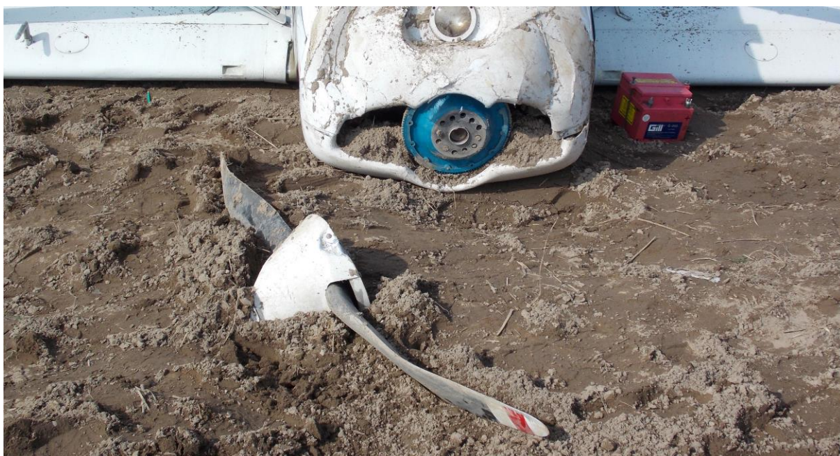
Rys. 3. Czołowa część samolotu na miejscu wypadku. Z przodu oddzielone od silnika śmigło. [foto PKBWL]
