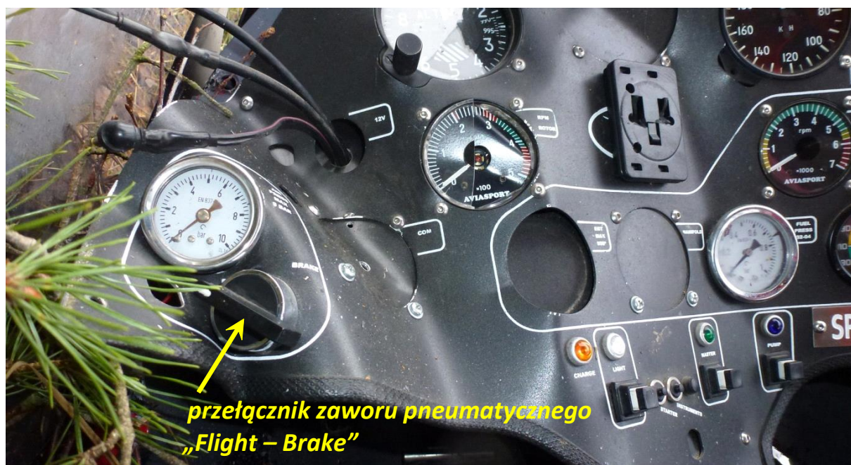
Fot. 7. Widok przełącznika „Flight – Brake” – ustawienie w położeniu do lotu
