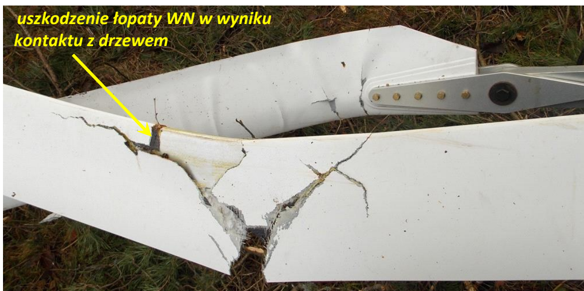
Fot. 5. Widok uszkodzenia łopaty WN w wyniku kontaktu z drzewem
