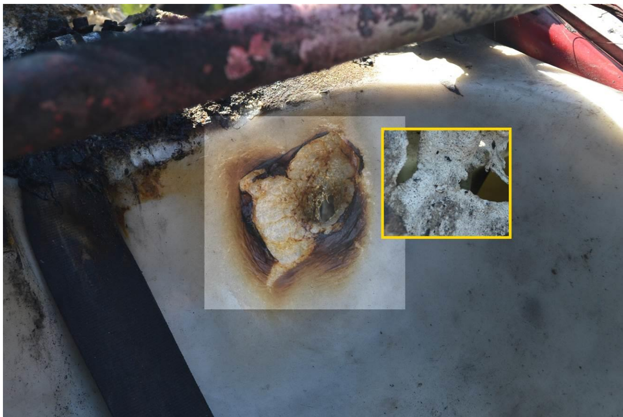
Fot. 8. Zdjęcie ukazuje wykonany przetop – rozjaśniony dla większej czytelności, dodatkowo w żółtej ramce pokazano fragment wypalonego pożarem zbiornika. Fot. PKBWL.
