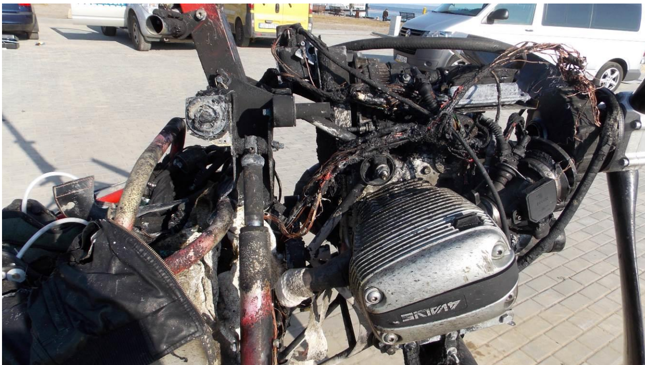
Fot. 6. Zdjęcie ukazuje zakres pożaru. Fot. PKBWL.
